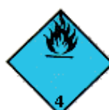
Látky, které s vodou vyvíjejí hořlavé plyny
