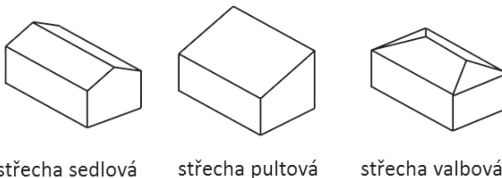
Obr. 10 Příklady tvarů střech - sedlová, pultová, valbová
